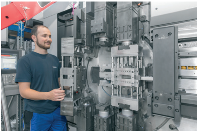
Sencillo cambio de herramienta del sistema de estampado progresivo LEANTOOL (Foto: Bihler)
